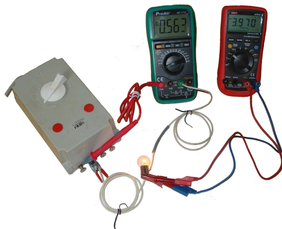
Obrázek 2.23: Měření voltampérové charakteristiky autožárovky „doma“.
