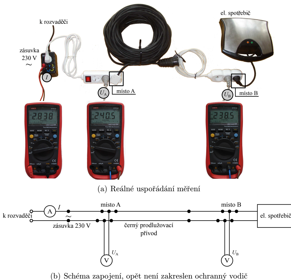
Obrázek 2.12: Zkoumání úbytku napětí na prodlužovacích přívodech.
