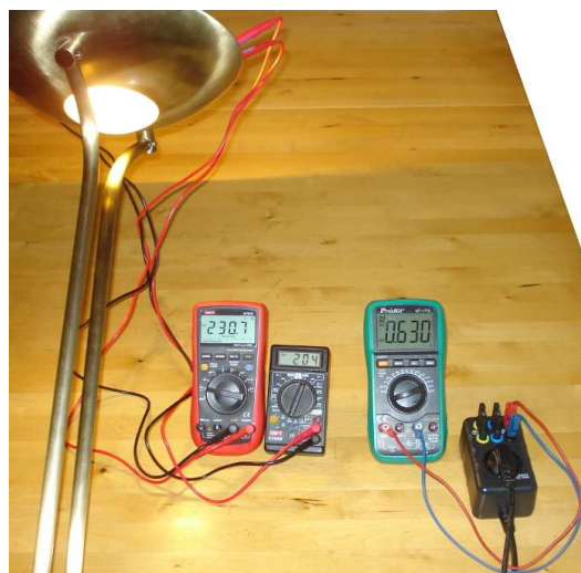
Obrázek 2.26: Měření charakteristiky halogenové žárovky.
