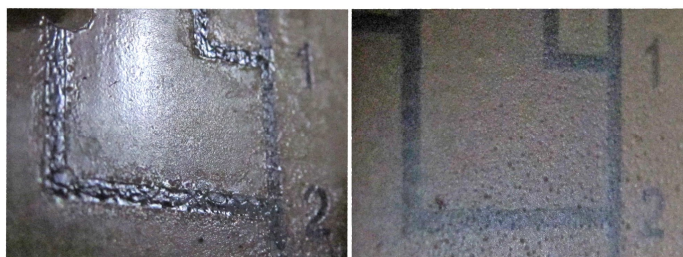
Obr. 13 – Rozdíl v povrchu akrylového a alkydového laku
