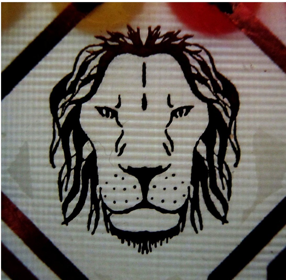
Obr. 10 – Grafika testovací desky vyleptaná v mědi
