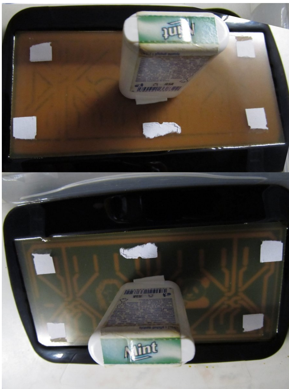
Obr. 9 – Testovací deska během leptání
