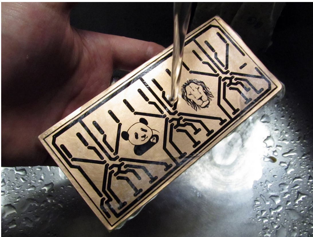
Obr. 8 – Testovací deska při oplachu
