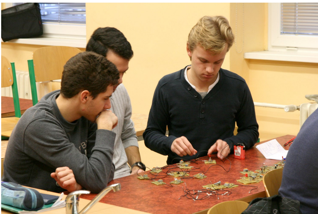
Průběh zapojování blikáče s IO NE555
