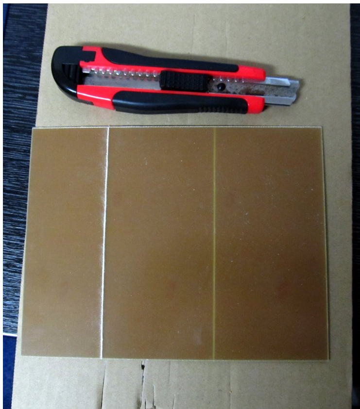
Obr. 14 – Dělení cuprexitu pomocí segmentového nože
