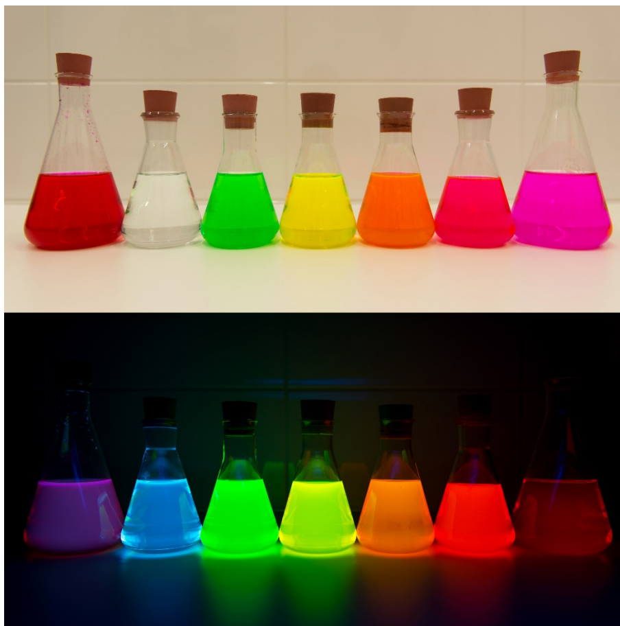
Obr. 5: Porovnání luminiscenčních roztoků na světle a pod UV zářivkou (zleva: směs rhodaminu a chininsulfát dihydrátu, chininsulfát dihydrát, výluh ze zeleného zvýrazňovače, fluorescein, eosin Y, rhodamin B v ethanolu, rhodamin B v 0,1M-H 2 SO 4 ).
